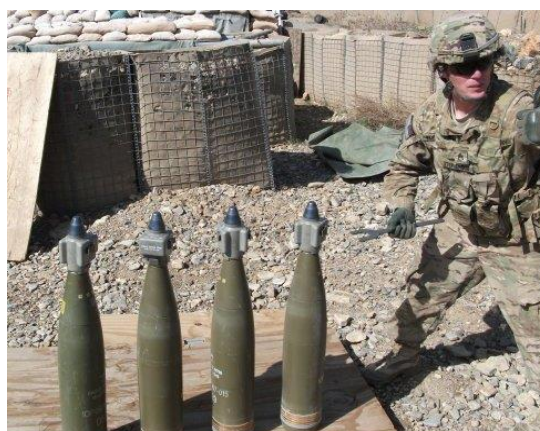
Рис. 1. XM1156 PGK (PROJECTILE GUIDANCE KIT, комплект точного наведення снаряду)
