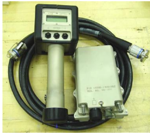
Рис. 9. Enhanced Portable Inductive Artillery Fuze Setter (EPIAFS) (ліворуч – встановлювач, праворуч – блок синхронізації з системою управління вогнем)
