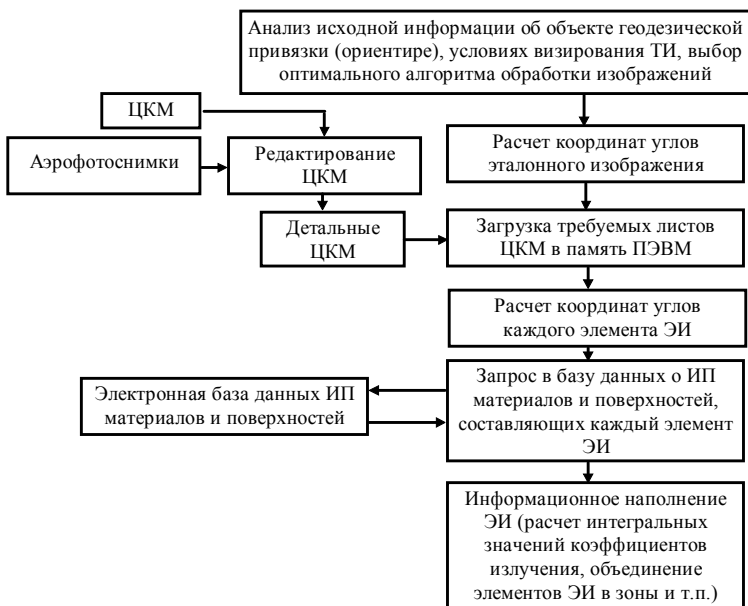
Рис. 2. Функциональная схема процесса синтеза эталонных изображений достижений геоинформационной технологии методика синтеза эталонных изображений.
