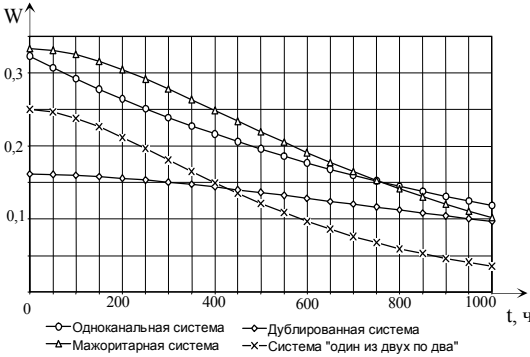
Рис. 3. График зависимости эффективности систем контроля от длительности режима ожидания
