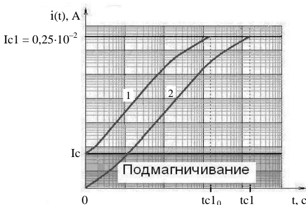
Рис. 1. Амплитудно-временная зависимость транспортного тока ВТСП в S-состоянии: 1 – с учетом внешнего подмагничивания; 2 – без внешнего воздействия
