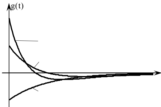
Рис. 4. Импульсные характеристики моделей СИТ, включающих дифференцирующие и инерционные звенья
