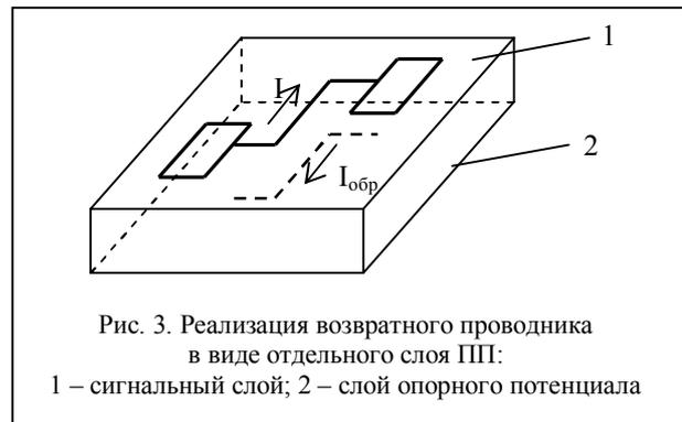
Рис. 3. Реализация возвратного проводника в виде отдельного слоя ПП: 1 – сигнальный слой; 2 – слой опорного потенциала
