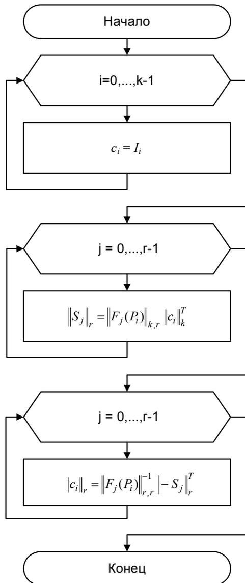
Рис. 3. Схема алгоритма помехоустойчивого кодирования алгеброгеометрическими кодами на пространственных кривых через проверочную матрицу
