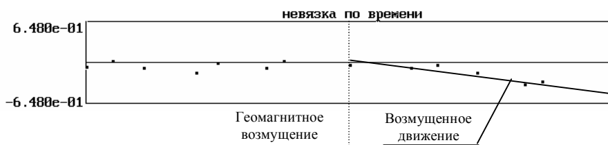
Рис. 3. Невязки по времени момента прохождения восходящего узла орбиты КА 23657 «Сич-1» в период геомагнитной возмущенности 14.04.2006 г
