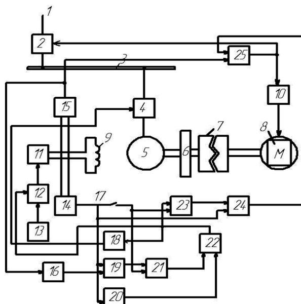
Рис. 3. Способ автоматического управления системой гарантированного питания
