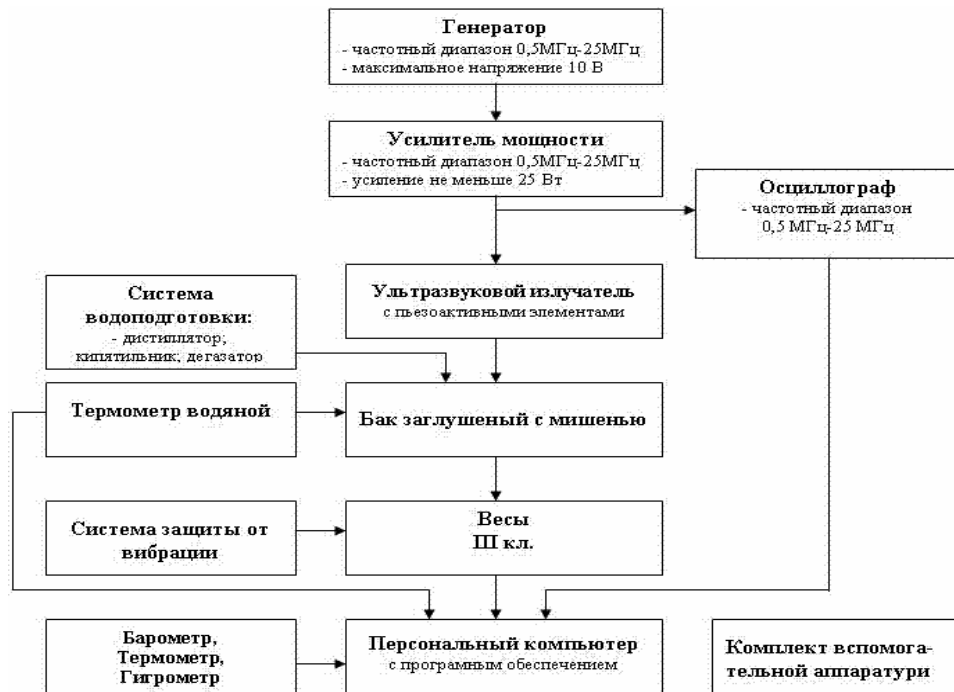
Рис. 2. Структурная схема эталона (первый предварительный вариант)
