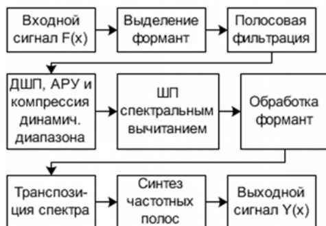
Рис. 3. Структурная схема алгоритма повышения разборчивости речи в ПЦОС
