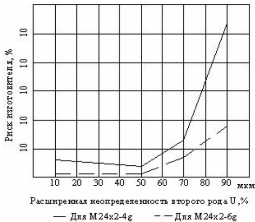
Рис. 2. Зависимость процента неправильно забракованных деталей с резьбой от величины расширенной неопределенности типа В
