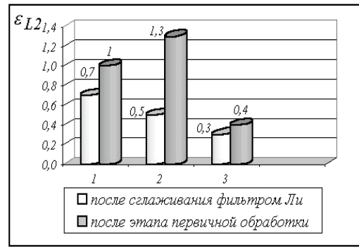
Рис. 3. Относительные общие ошибки оценки УЭПР в норме L2 после этапа первичной обработки и после сглаживания фильтром Ли: 1 – бистатическая PCA, согласованная фильтрация принимаемого сигнала, 2 – бистатическая PCA с декорреляцией принятого сигнала, 3 – многопозиционная PCA
