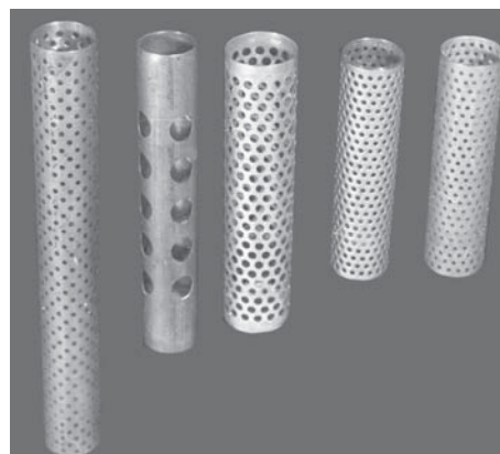
Рис. 2. Образцы перфорированных трубок, изготовленные методом ГДШ на пресс-пушках с располагаемой энергией до 20 кДж
