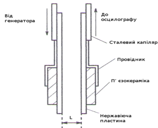
Рис. 1. Схема прийомопередаючої системи для дослідження швидкості звуку в емульсії
