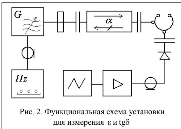
Рис. 2. Функциональная схема установки для измерения  $\epsilon$  и  $\operatorname{tg}\delta$
