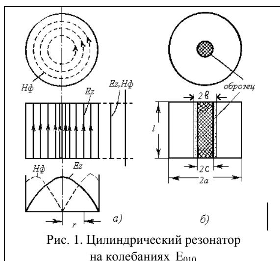
Рис. 1. Цилиндрический резонатор на колебаниях  $E_{010}$
