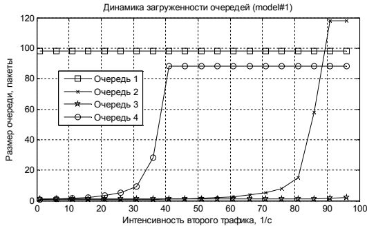
Рис. 3. Анализ загрузки очередей в рамках модели model#1
