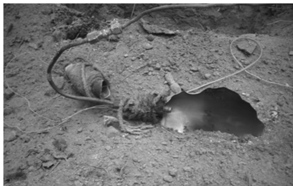
Рис. 1. Фото гидридных систем хранения водорода после их разрушения
