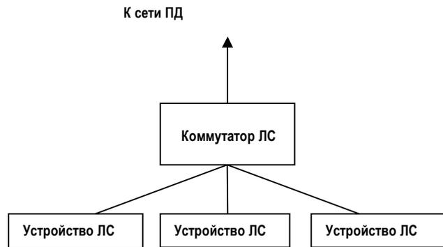
Рис. 4. Схема организации проводной локальной сети
