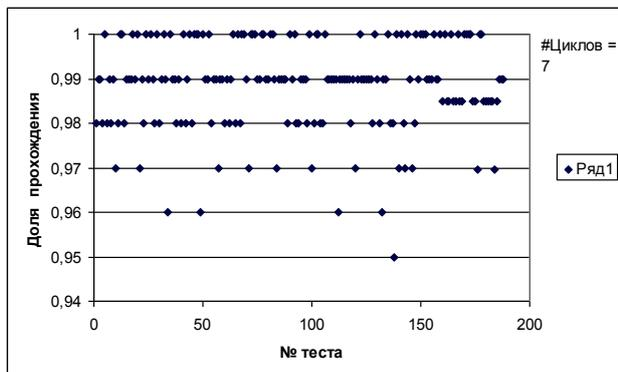
Рис. 41. Прохождение тестов 7-ми цикловым шифром
