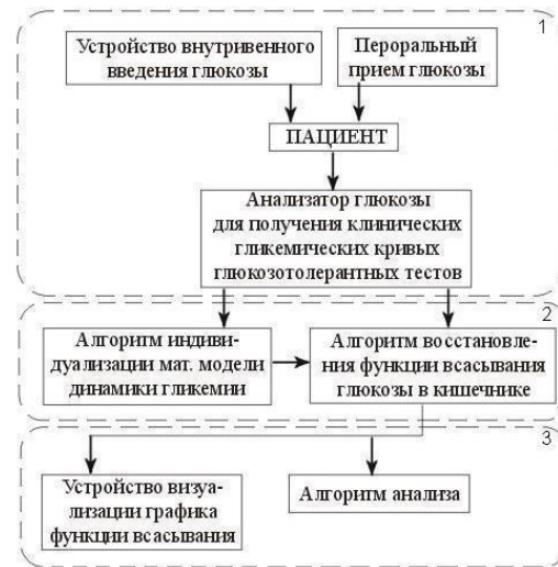
Рис. 3. Структурная схема системы автоматизированного определения вида функции всасывания глюкозы
