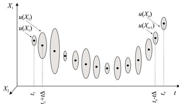
Рис. 2. Отображение результатов измерения динамической переменной  $X$  в моменты времени  $t_i$ , выполненные с интервалом  $\Delta t$
