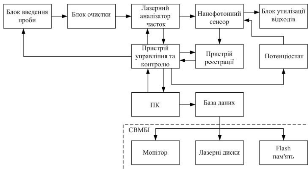
Рис. 6. Схема інформаційної системи для отримання та обробки аналітичної інформації
