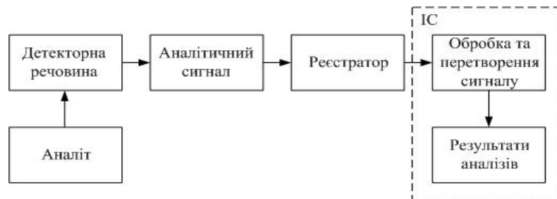
Рис. 1. Функціональна схема вимірювань за допомогою фізико-хімічного сенсора
