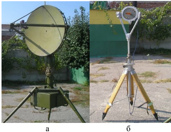
Рис. 6. Исследуемая параболическая (а) и вспомогательная антенны (б)
