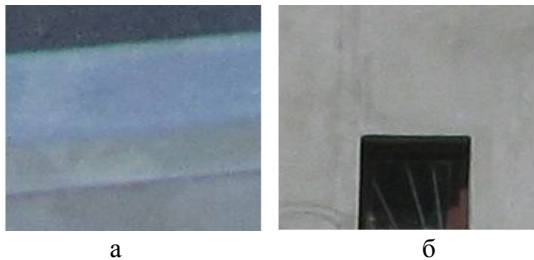
Рис. 5. Входные данные для проведения измерений координат а – изображение с размытыми границами вследствие вибрирования МБПЛА, б – качественное изображение.
