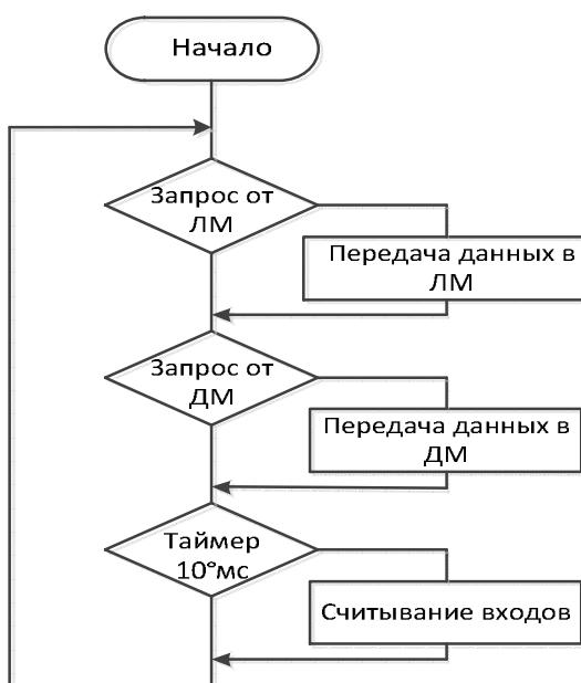
Рис. 1. Алгоритм программы модуля ввода дискретных сигналов
