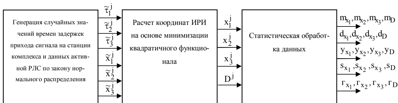
Рис. 3. Функциональная схема статистического моделирования вычисления координат ИРИ методом Монте-Карло
