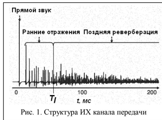
Рис. 1. Структура ИХ канала передачи
