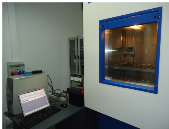
Рис. 5. Подключение датчиков температуры из климатической камеры KPK 400 к системе сбора данных Agilent 34970A
