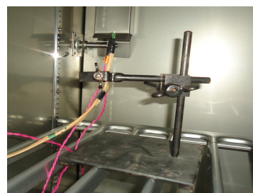
Рис. 4. Размещение термисторов T10 К и термосопротивления Pt 100 в климатической камере KPK 400
