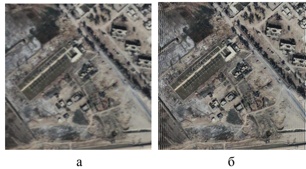
Рис. 1. Оптико-електронні зображення (Фаллуджа, Ірак): а – зображення в умовах роз фокусування та змазування; б – відновлене зображення з використанням ітеративного методу Ландвебера (8)
