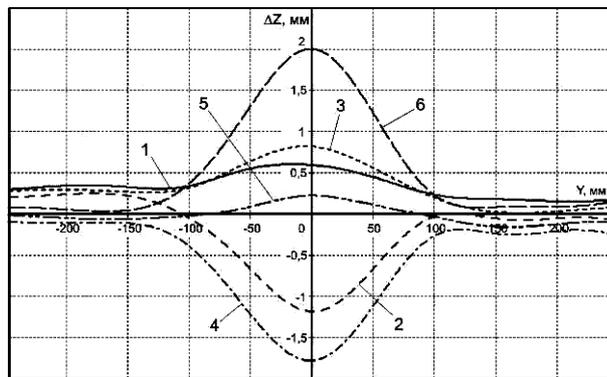
Рис. 13. Отклонение фактических координат точек обводообразующей поверхности монолитной панели от принятых номинальных значений для каждого этапа деформирования в сечении Y'Z'
