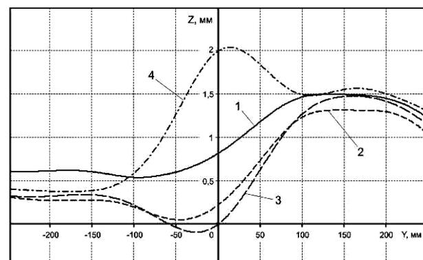
Рис. 11. Распределение точек обводообразующей поверхности монолитной панели в сечении  $Y'Z'$
