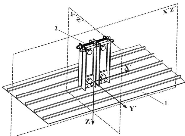
Рис. 1. Образец монолитной панели с установленным экспериментальным устройством для выполнения технологической операции правки и доводки в ручном режиме:
