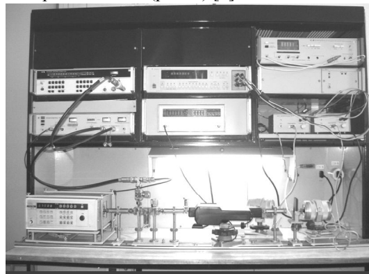
Рис. 2. Внешний вид лабораторной установки для измерения мощности отраженного и прошедшего сигнала на частоте 70-78 ГГц
