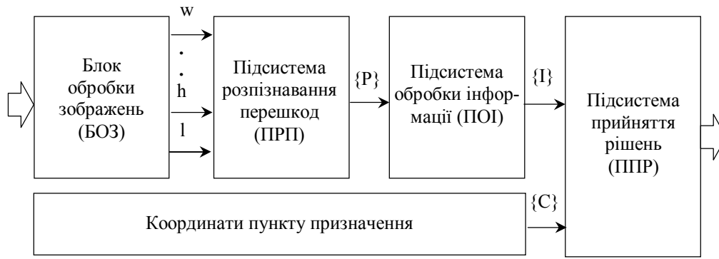
Рис. 1. Структурна схема системи обробки інформації при управлінні мобільним роботом, де l, h, w – геометричні параметри об’єкта; \{P\} – множина параметрів об’єкта; \{I\} – множина оцінок оточуючих предметів; \{C\} – координати пункту призначення
