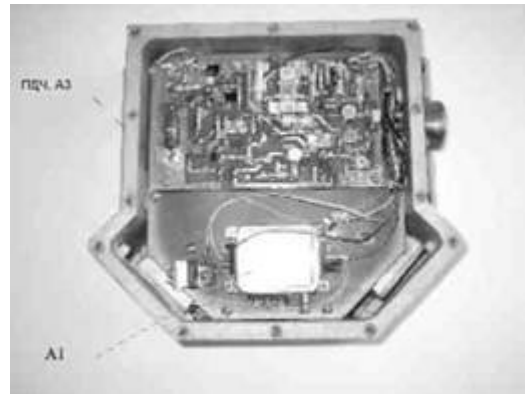
Рис. 4. Верхня частина корпусу ППМ
