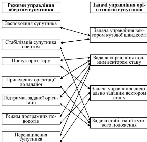
Рис. 7. Схема взаємозв'язку між режимами управління обертом супутника та задачами управління орієнтацією супутника
