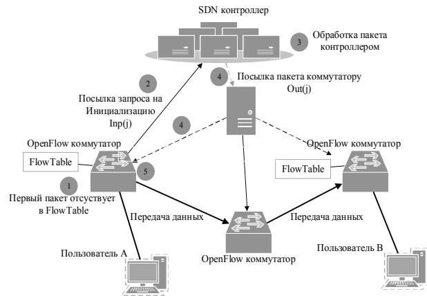
Рис. 2. Формирование управляющего потока в SDN
