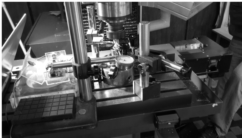
Рис. 3. Стенд для вимірювання вільних коливань і вібропереміщень інструменту
