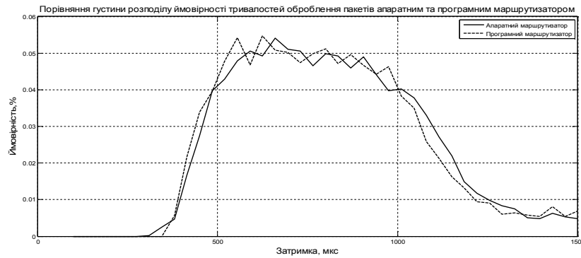
Рис. 7. Порівняння густини розподілу ймовірностей тривалостей оброблення пакетів комутатором із 3-ма апаратними та 3-ма програмними маршрутизаторами, протягом періоду 0...14 хв експерименту
