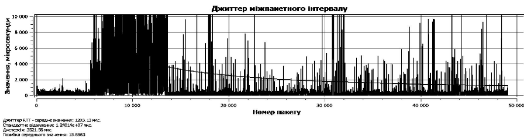
Рис. 12. Джиттер при передаванні IPTV трафіку через агрегуючий маршрутизатор без застосування MPQ та при його використанні
