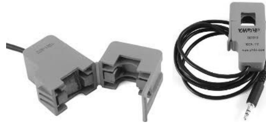
Рис. 6. Датчик тока мод. STC-013
