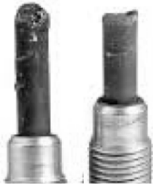
Рис. 2. Типы поломок свечей накаливания [7]
