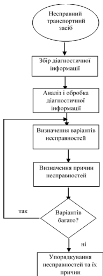
Рис. 1. Узагальнений процес діагностики транспортного засобу
