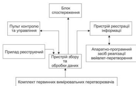
Рис. 7. Структурна схема комплексу СКУБ-М2 з включеним до його складу апаратно-програмним засобом ТСВП
