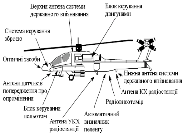
Рис. 3. Критична до впливу НВЧ-випромінювання електронна апаратура вертольоту
