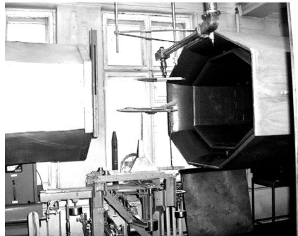
Рис. 1. Зовнішній вигляд робочої частини аеродинамічної труби Т-1
