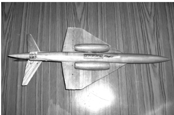
Рис. 5. Розміщення мотогондол двигунів під крилом
