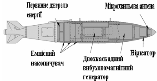
Рис. 15. Варіант розміщення бойової частини електромагнітної дії в корпусі авіаційної бомби GBU-31/Мк.84
