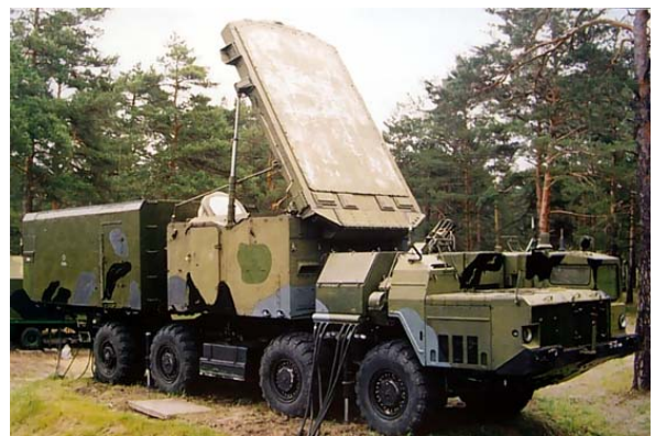
Рис. 1. Радіолокатор підсвіту і наведення 30Н6
