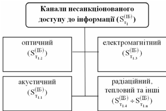
Рис. 8. Загальна структура каналів несанкціонованого доступу до інформації
