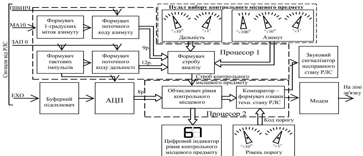
Рис. 2. Структурна схема пристрою оцінки технічного стану РЛС за параметрами прийнятого сигналу від контроль-ного місцевого предмету
