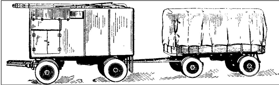
Рис. 41. Передвижна трансформаторна підстанція потужністю 75 кВа при напругі 6600/230/133 В
