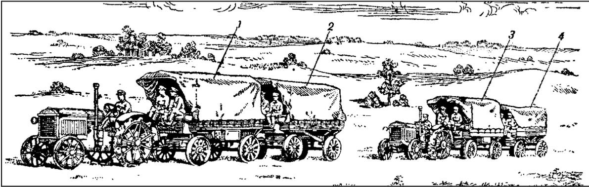
Рис. 25. Передвижная электростанция переменного тока ТЭС-1 (1934 г.):
