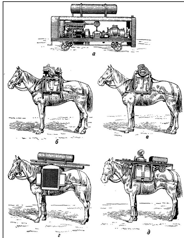
Рис. 30. Вьючная электростанция ВЭС-1,5 (1943 г.):
