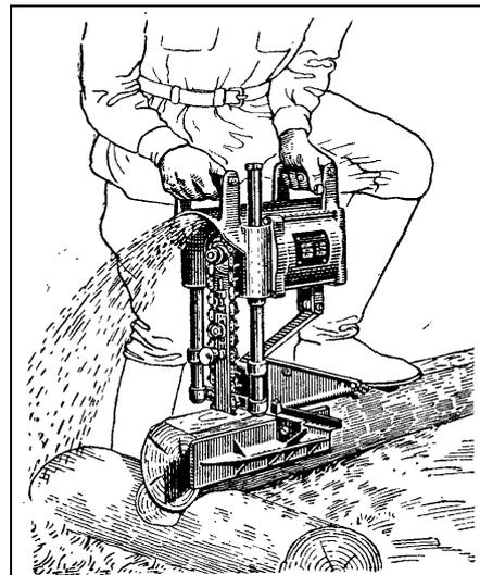
Рис. 11. Работа электродолбежником
