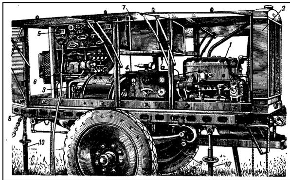
Рис. 29. Передвижная автомобильная станция ПЭС-15 с агрегатом на прицепе (1942 г.)
