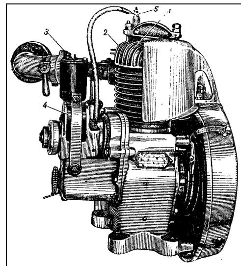
Рис. 34. Двигатель типа В-3: 1 – цилиндр; 2 – ребра;
