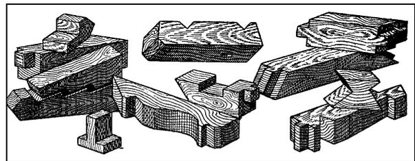
Рис. 9. Детали, выделяемые переносной ленточной пилой
