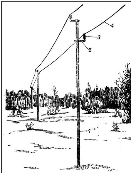
Рис. 5. Шестовая линия сильных токов:
