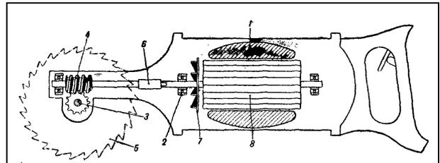
Рис. 10. Кинематическая схема круглой пилы
