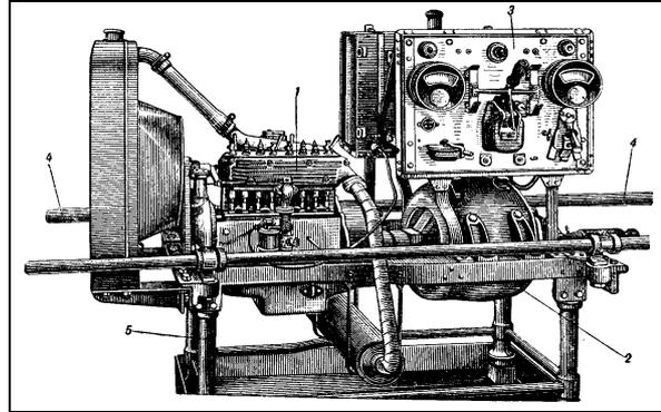
Рис. 1. Переносная генераторная установка мощностью 5,5 кВт (1916 г.):
