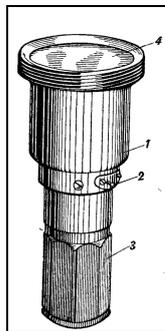
Рис. 38. Фонарь с пружинным заводом
