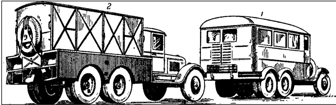
Рис. 28. Передвижная электростанция переменного тока АЭС-4 (1937 г.):
