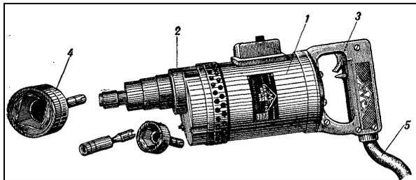
Рис. 16. Электрический торцовый ключ-отвертка:
