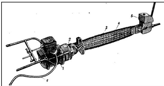
Рис. 7. Поперечная электропила для валки деревьев:
