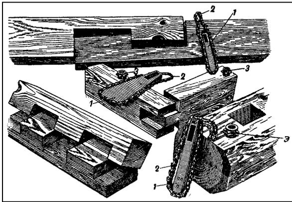
Рис. 12. Образцы врубок, производимых долбежником:
