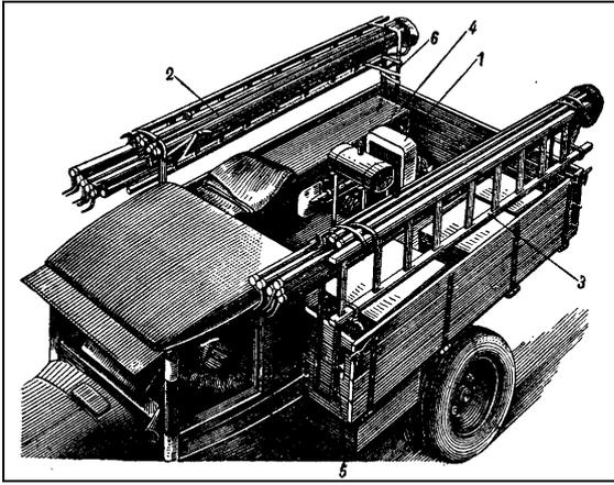
Рис. 21. Передвижная электростанция постоянного тока ЭС-1 (1931 г.)
