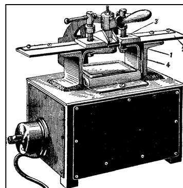
Рис. 18. Паяльный аппарат для пайки
