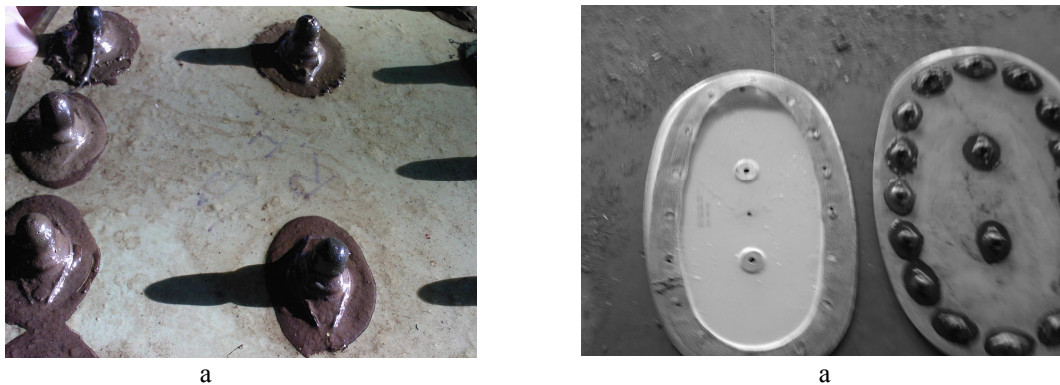
Рис. 4. Разрушение метаболитами уплотнений и герметиков
